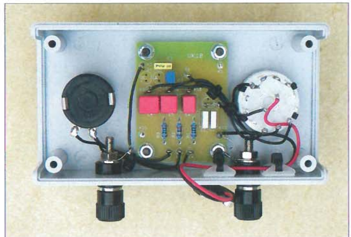
Bild 11: Abstimmbox mit Kapazitätsdiode und drei zuschaltbaren FKP2-Festkondensatoren
