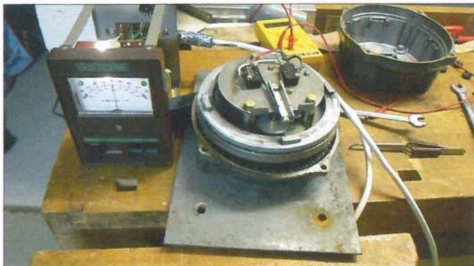
Bild 1: Montage und Justieren des oberen Drehtellers; der Mitnehmer unter dem Endschalterhebel sowie das montierte Zahnrad auf der Achse des Potenziometers sind gut zu erkennen. Der Rotor befindet sich in Stellung Norden.
