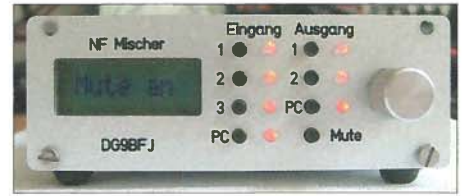
Bild 5: Soll keines der Eingangssignale eines der angeschlossenen Geräte erreichen, ist der Taster Mute zu betätigen.
