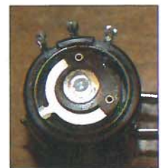
Bild 3: Geöffnetes Potenziometer mit verschmutzter Drahtwendel
