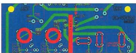
Bild 2: Teil des Sprint-Layout-Entwurfs einer HF-Platine; die dicken grünen Leiterzüge sind 50-Ω-Mikrostreifenleitungen. Die Massefläche (blau) ist auf der anderen Seite.
