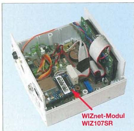
Bild 1: Blick in das geöffnete Gehäuse der Basisstation mit dem WIZnet-Modul unten links
