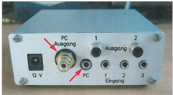
Bild 2: Rückplatte mit Ein- und Ausgängen, von denen zwei isoliert montiert sind (Pfeile)
