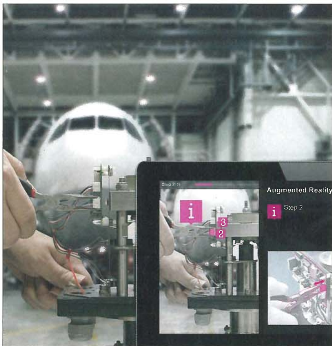
Als mögliche Anwendung unterstützt AR in der Flugzeughalle die Wartungsarbeiten des Technikers durch Einblendungen ins Livebild des Tablet-Computers.
