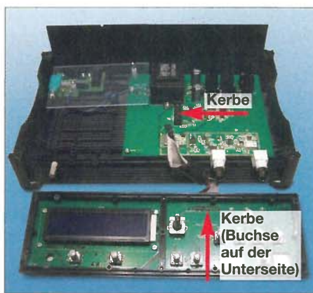
Bild 3: Bestückte Platinen mit Display und Bedienelementen (oben) und der Hauptleiterplatte (unten)
