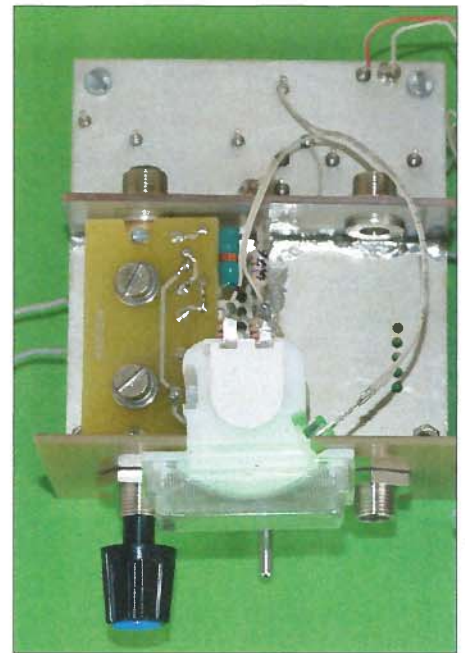
Bild 22: Das Indikatorinstrument wird mit einer LED beleuchtet. Fotos: DG0KW
