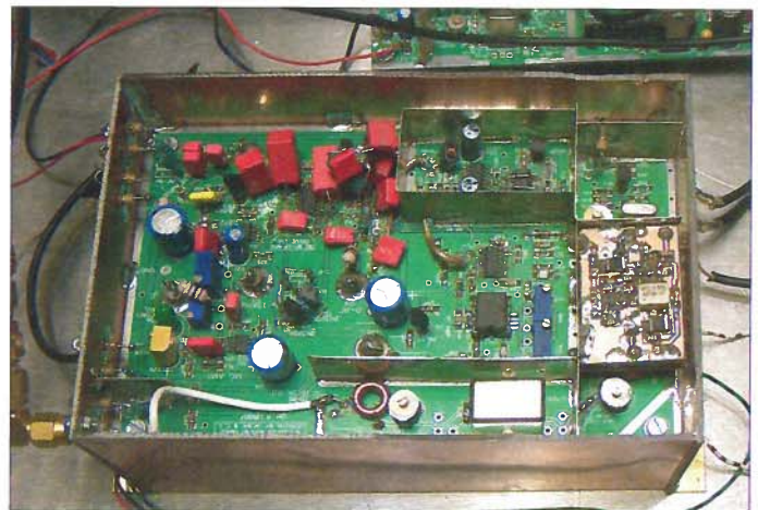
Bild 2: Blick auf die auf der Oberseite des Zwischenblechs montierten Baugruppen
