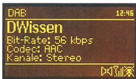
Bild 4: Bei DAB/DAB+-Empfang lassen sich auf dem LC-Display technische Daten der Übertragung abrufen.
