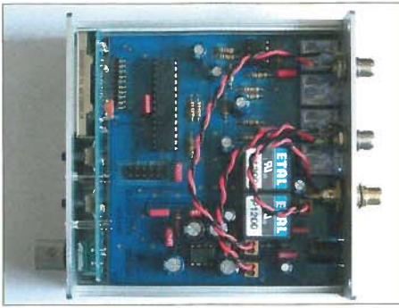
Bild 6: Innenansicht des geöffneten Gehäuses; die drei NF-Ausgangsbuchsen werden über verdrehte Leitungen und Steckverbinder mit der Leiterplatte verbunden.
