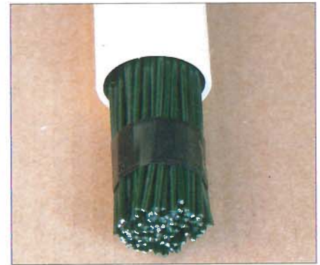
Bild 3: Gebündelte kunststoffummantelte Weicheisendrähte sind bei niedrigen Frequenzen eine preiswerte Alternative zu speziellen Ferritstabkernen.
