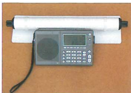
Bild 5: Kompakte abstimmbare Zusatz-Ferritantenne im Schutzrohr; links ragt der Betätigungsknopf des Drehschalters und rechts der des Drehkondensators heraus.
