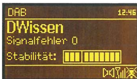
Bild 8: Die im DAB/DAB+-Modus abrufbare Signalstärkeanzeige hilft bei der optimalen Ausrichtung der Teleskopantenne. Eine externe Antenne ist im Originalzustand nicht anschließbar.
