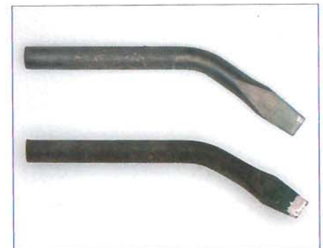
Bild 11: Nach der Behandlung mit Löt fett lässt sich die ursprünglich verzinderte LötKolbenspitze wieder gut verzinnen (unten).
