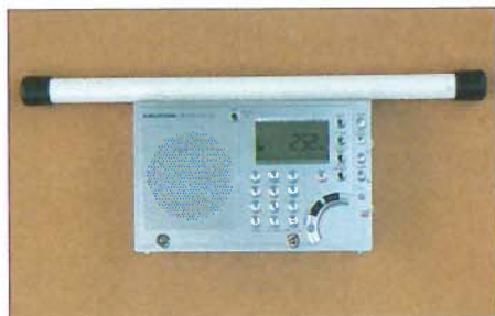
Bild 2: Ein parallel zur internen Ferritantenne ausgerichteter zusätzlicher Stabkern entzieht der Antenne Energie, die Empfangsleistung wird in diesem Fall abgeschwächt.
