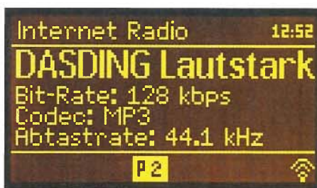
Bild 5: Auf Wunsch zeigt das Display beim Web-Radioempfang die jeweiligen Übertragungsdaten.
