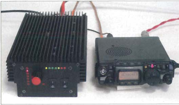
Bild 26: Der QRP-Transceiver FT-817 und die 50-W-Endstufe (hier noch der Prototyp) sind ein gutes Gespann und gemeinsam sowohl stationär als auch portabel einsetzbar.
